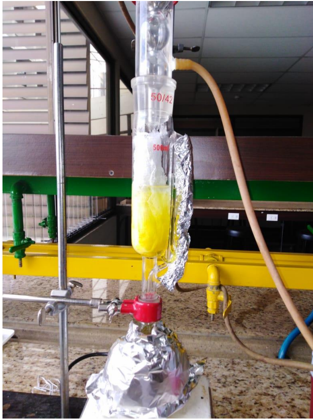
Figura 12. Segundo sifón, Comienza la Extracción por Medio del equipo Soxhlet (Fuente: Elaboración propia)
