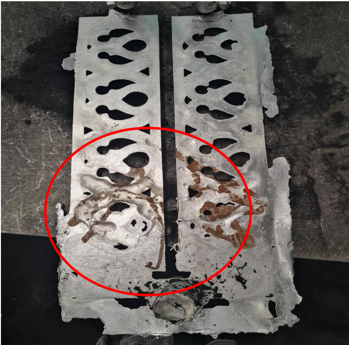
Figura 17: Ejemplo de rechupe
