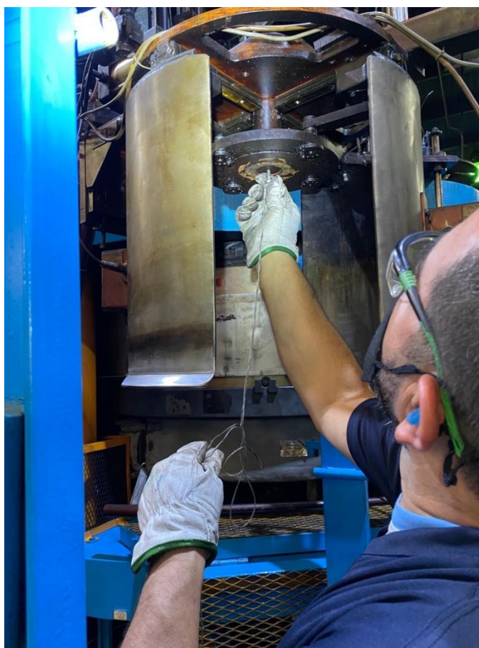
Figura 26. Colocación del cable con plomo en el centro del brazo
