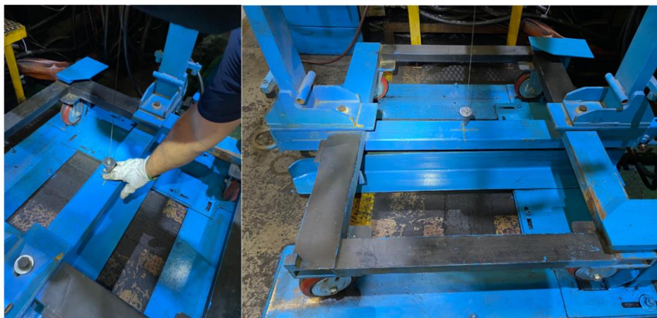
Figura 27. Alineamiento del plomo respecto al centro del servidor
