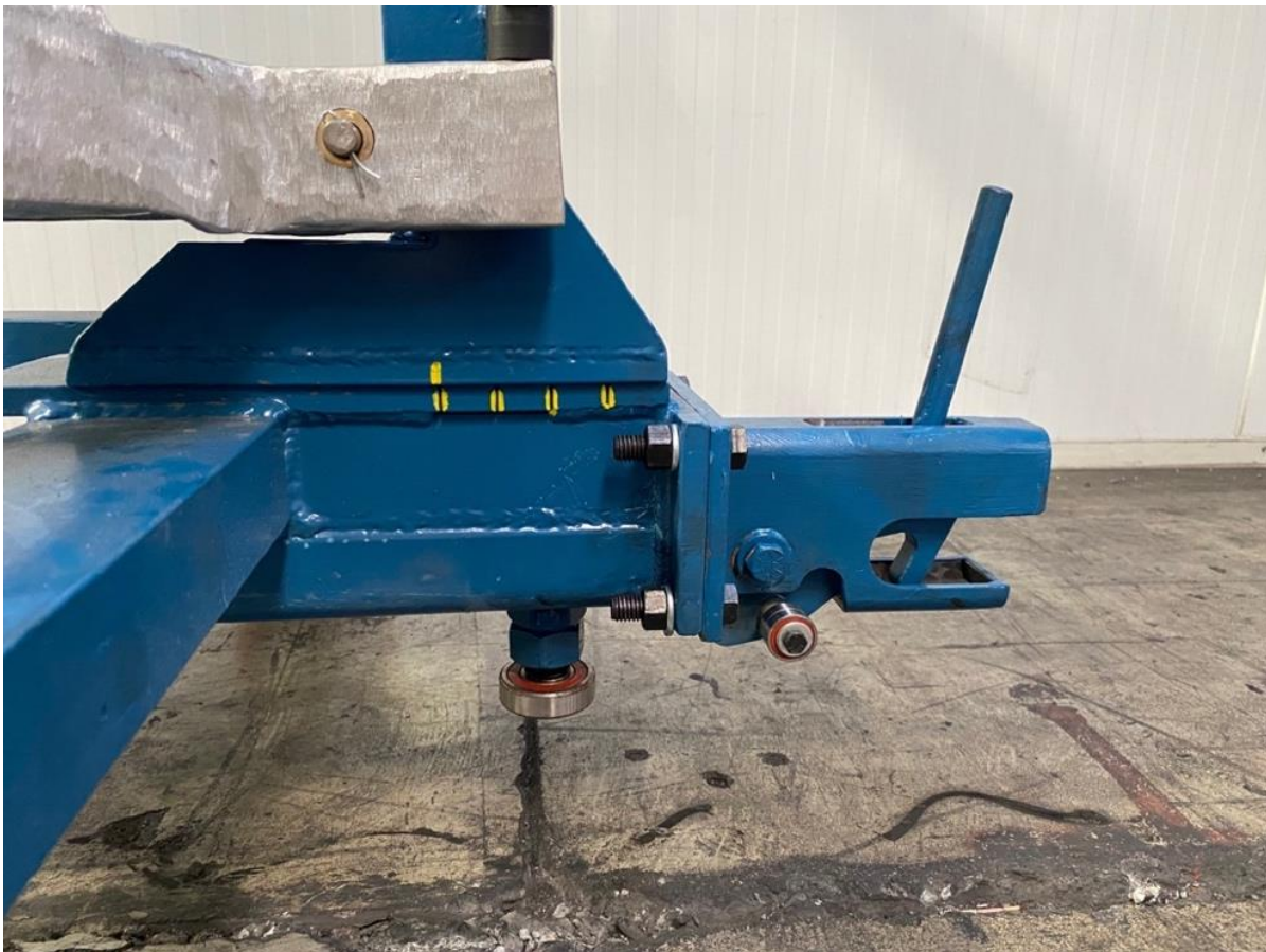
Figura 36. Marcaje lateral de los servidores estandarizados
