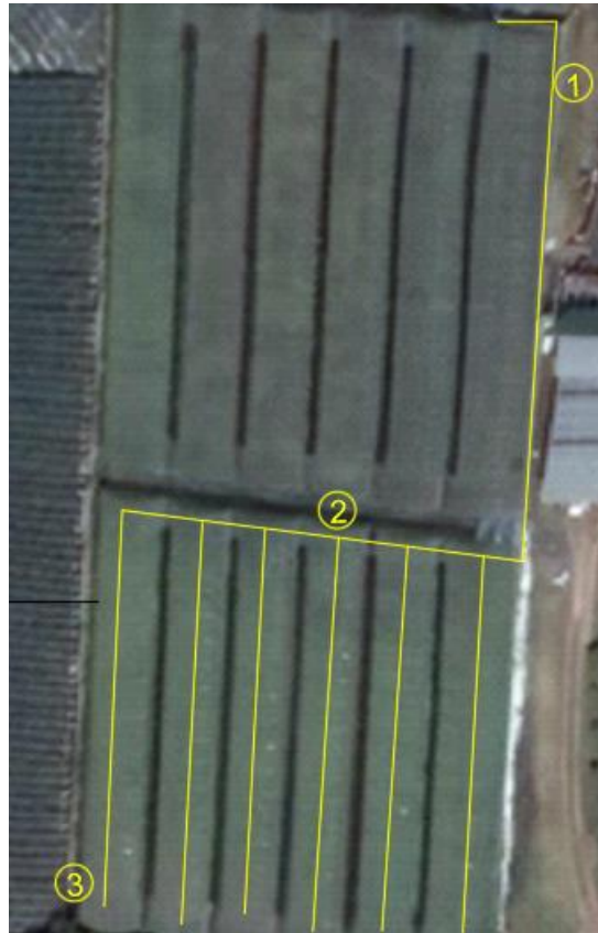
Figura 20, distribución y ruta crítica de la tubería
