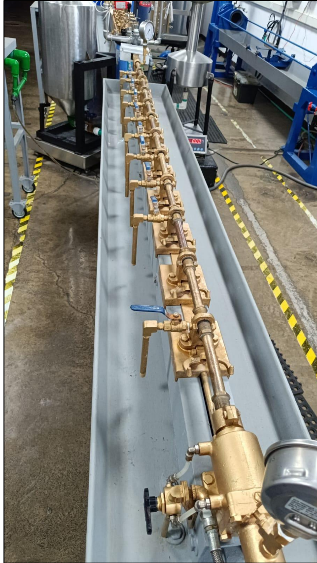
Figura 15. Banco de pruebas Ford DN 15 – 20.
