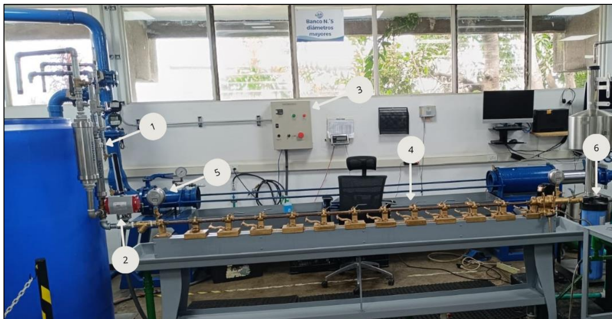
Figura 21. Distribución de los componentes en el Banco N°2.
