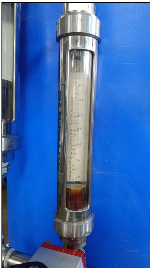
Figura 17. Rotámetro Krohne, utilizado en el Laboratorio de Flujo de Agua.
