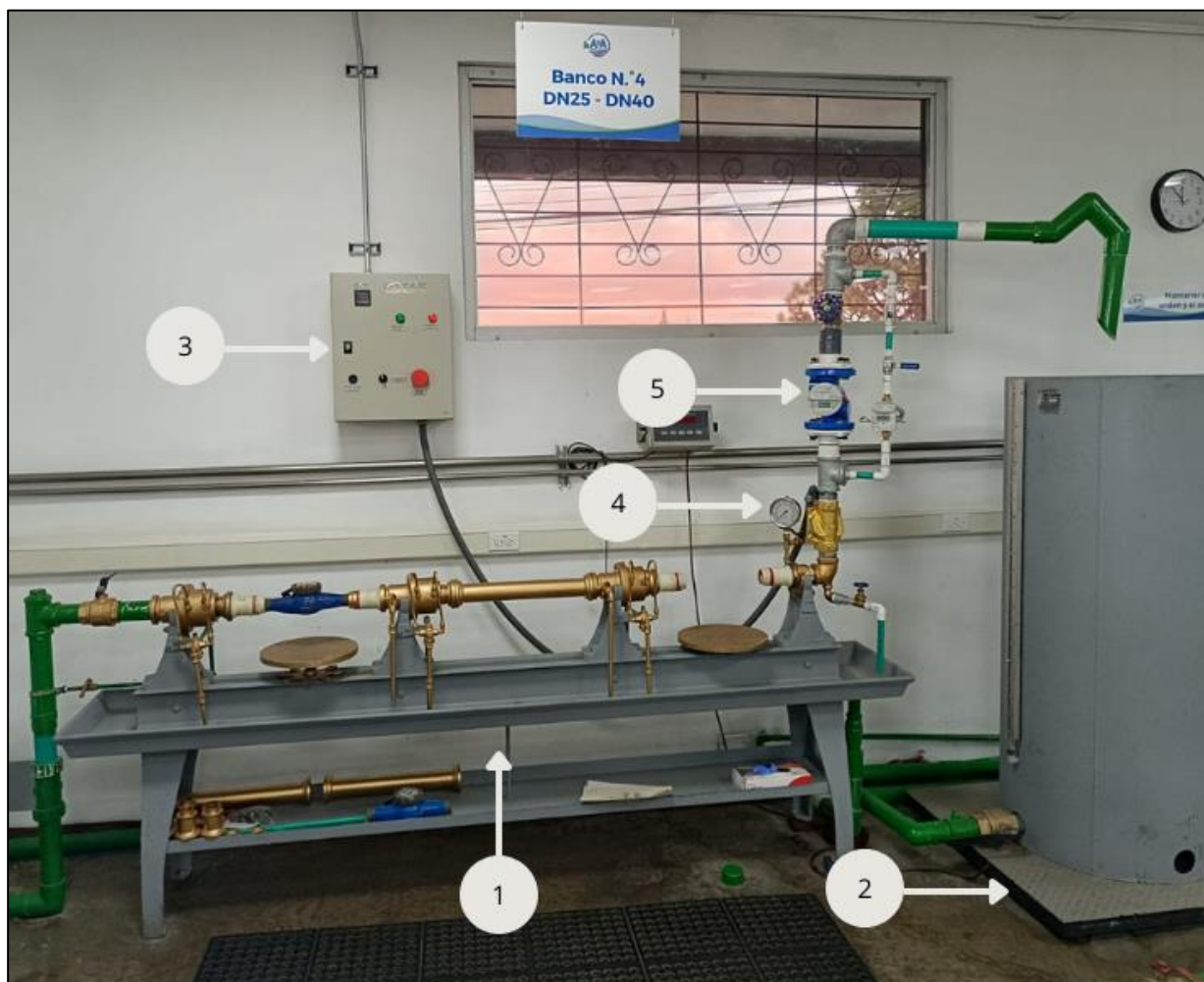
Figura 22. Distribución de los componentes en el Banco N°4.
