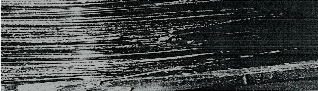
Figura: 10-35B: Un acercamiento de una falla del bobinado del motor. Courtesy of Jean-Claude Martin, Institut de Police Scientifique et Criminologie (IPSC), Lausanne Switzerland.
