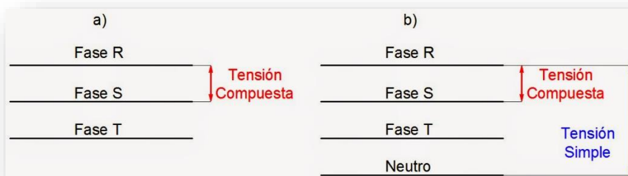
Ilustración 18. Esquema de una líneas trifásica. a) Conexión a tres hilos b) Conexión a cuatro hilos
