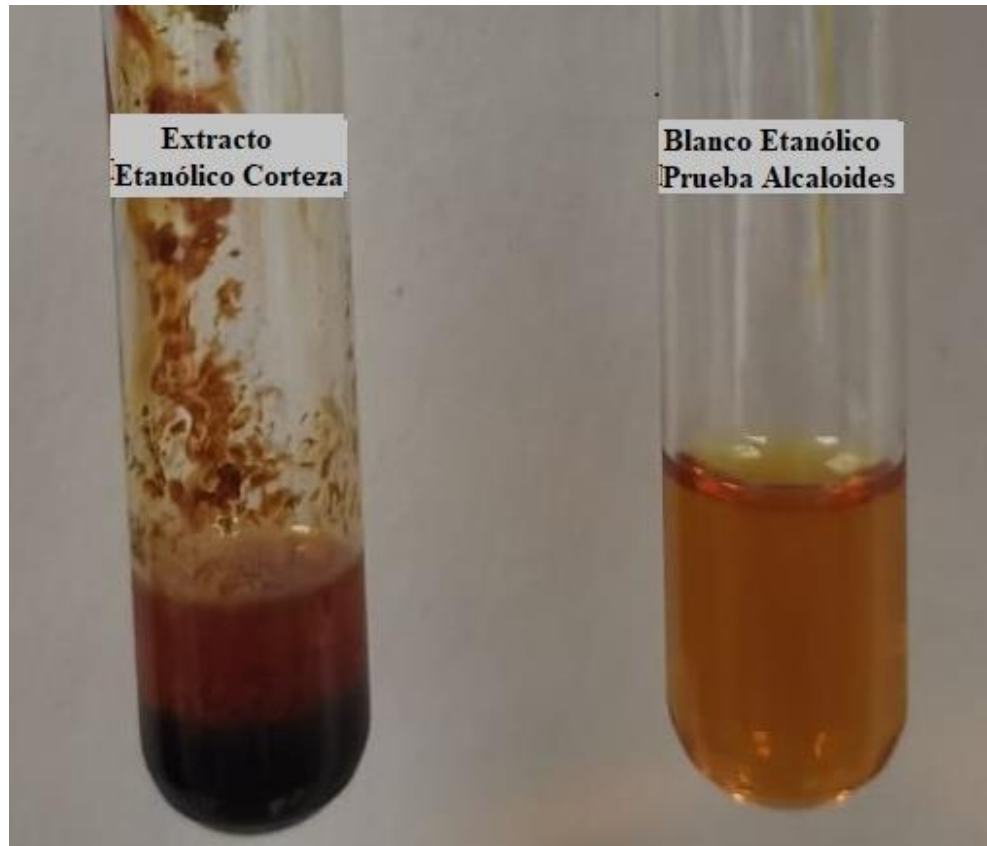
Figura 21. Prueba Para la Identificación de Alcaloides del Extracto Etanólico de la Corteza
