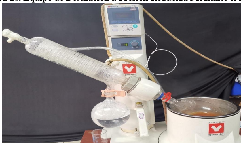
Figura 16. Equipo de Destilación a Presión Reducida Mediante el Rotavapor.
