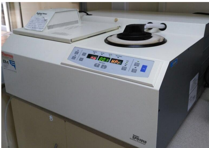
Figura 26. SpeedVec utilizado para la eliminación de solventes
