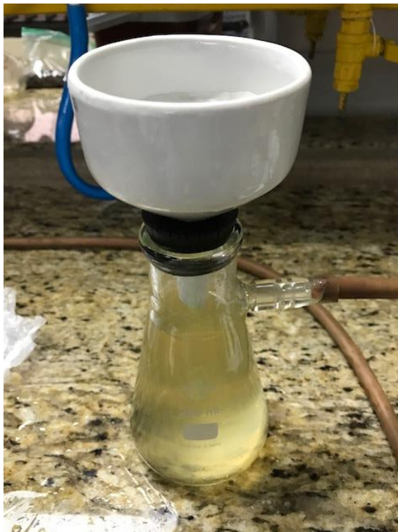
Figura 4. Equipo utilizado en filtración y concentrado del extracto acuoso
