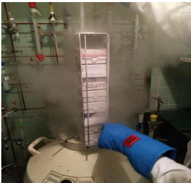
Figura 11. Proceso de congelamiento de la muestra con nitrógeno líquido
