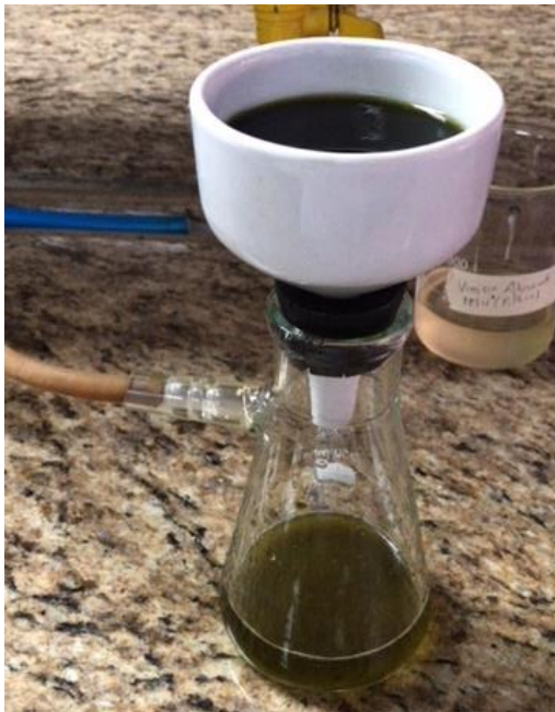
Figura 7. Equipo utilizado en filtración del extracto tratado con hexano
