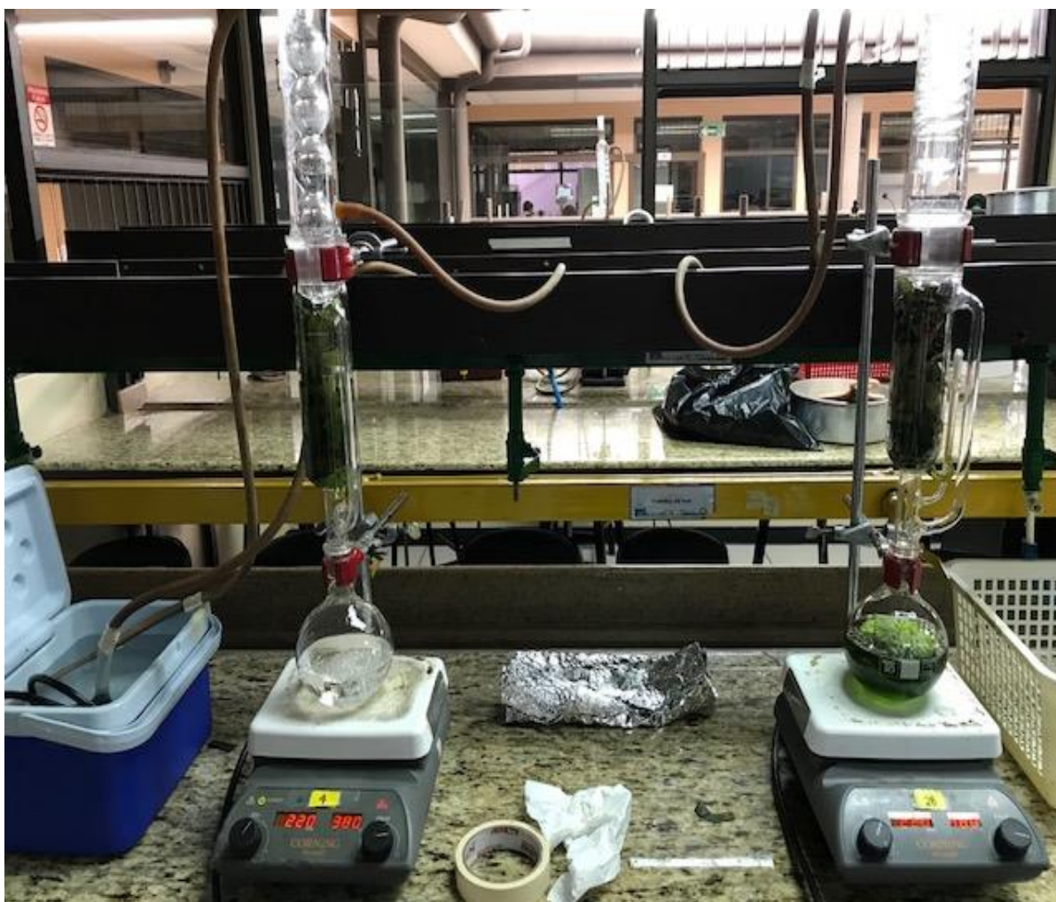
Figura 8. Equipo utilizado en extracción con etanol
