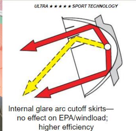
Imagen 28: Tipo de Instalación del bulbo dentro de la luminaria y configuración de la óptica y reflexión de las luminarias instaladas.
