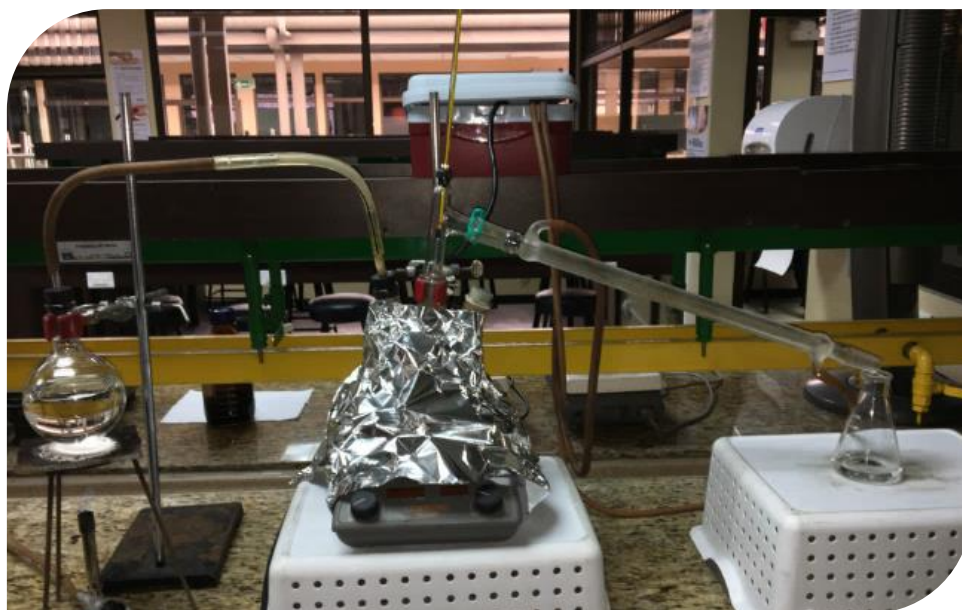
Figura 24. Equipo Arrastre por Vapor
