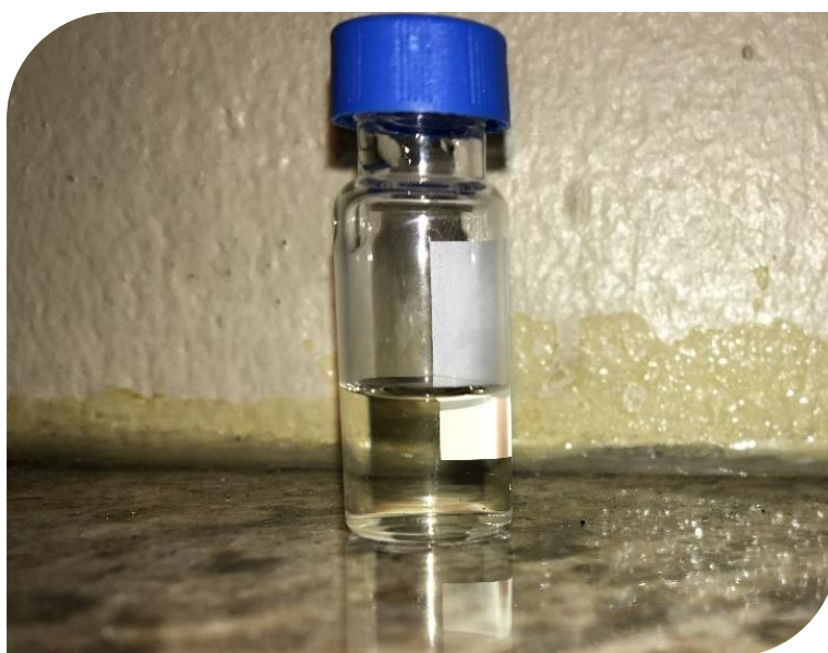
Figura 36. Obtención del Extracto de Broza de Coffea arábica por el Método Arrastre por Vapor
