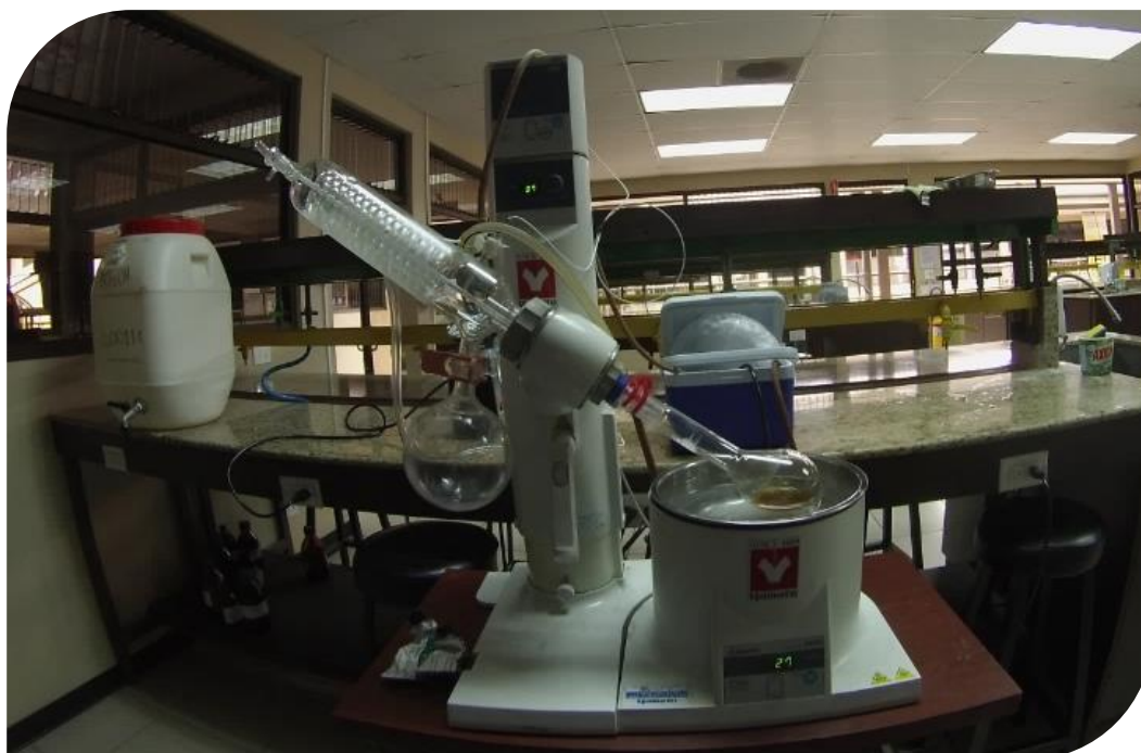
Figura 23. Equipo Rotavapor Yamato BM500
