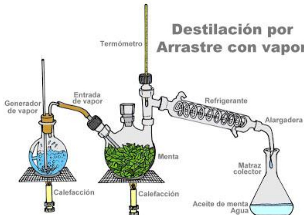
Figura 18. Equipo Arrastre por Vapor
