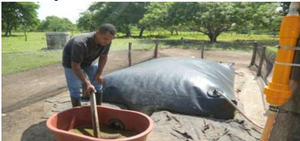
Figura 19. Biodigestor excreta animal 1
